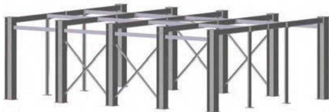
Трехмерная модель металлического каркаса
