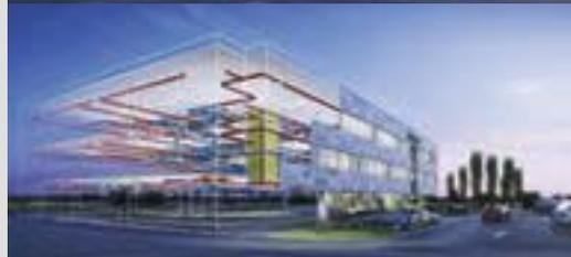
Визуализация проекта реконструкции одного из офисов Autodesk в США, сгенерированная из оригинальных наборов данных информационной модели здания. Видны структурные и конструктивные элементы, а также инженерные системы и т.д.
