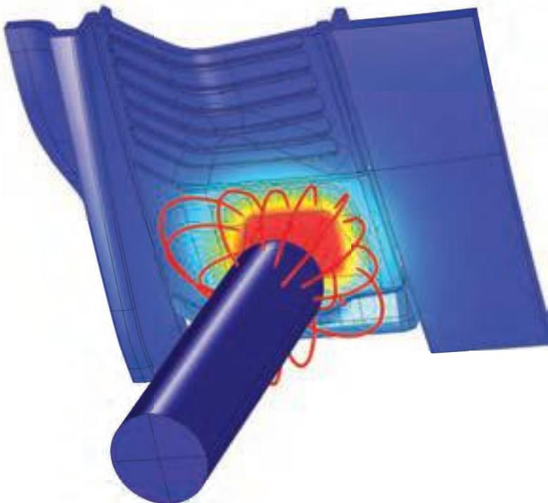
Рис. 3 Моделирование электростатических свойств системы емкостного сенсора и макета пальца.
